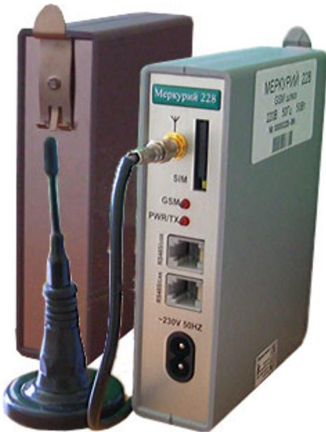
GSM-шлюз предназначен для организации удалённого доступа к устройству или группе устройств оснащённых последовательными интерфейсами RS-485. Имея тот же тип интерфейса он включается в сеть устройств, объединённых общим интерфейсным кабелем и обеспечивает дистанционный доступ к каждому прибору данной сети по каналу GSM\GPRS. При этом устройства могут различаться по типам, протоколам и параметрам связи.
