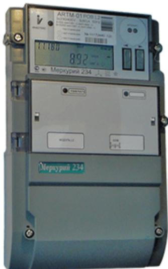
Счётчики предназначены для одно- или двунаправленного учета активной и реактивной электрической энергии и мощности в трехфазных 3-х или 4-х проводных сетях переменного тока через измерительные трансформаторы или непосредственно с возможностью тарифного учёта по зонам суток, долговременного хранения и передачи накопленной информации по цифровым интерфейсным проводным или беспроводным каналам связи в центры сбора информации.
