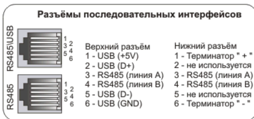
Рисунок 11.2 – Назначение контактов разъемов
