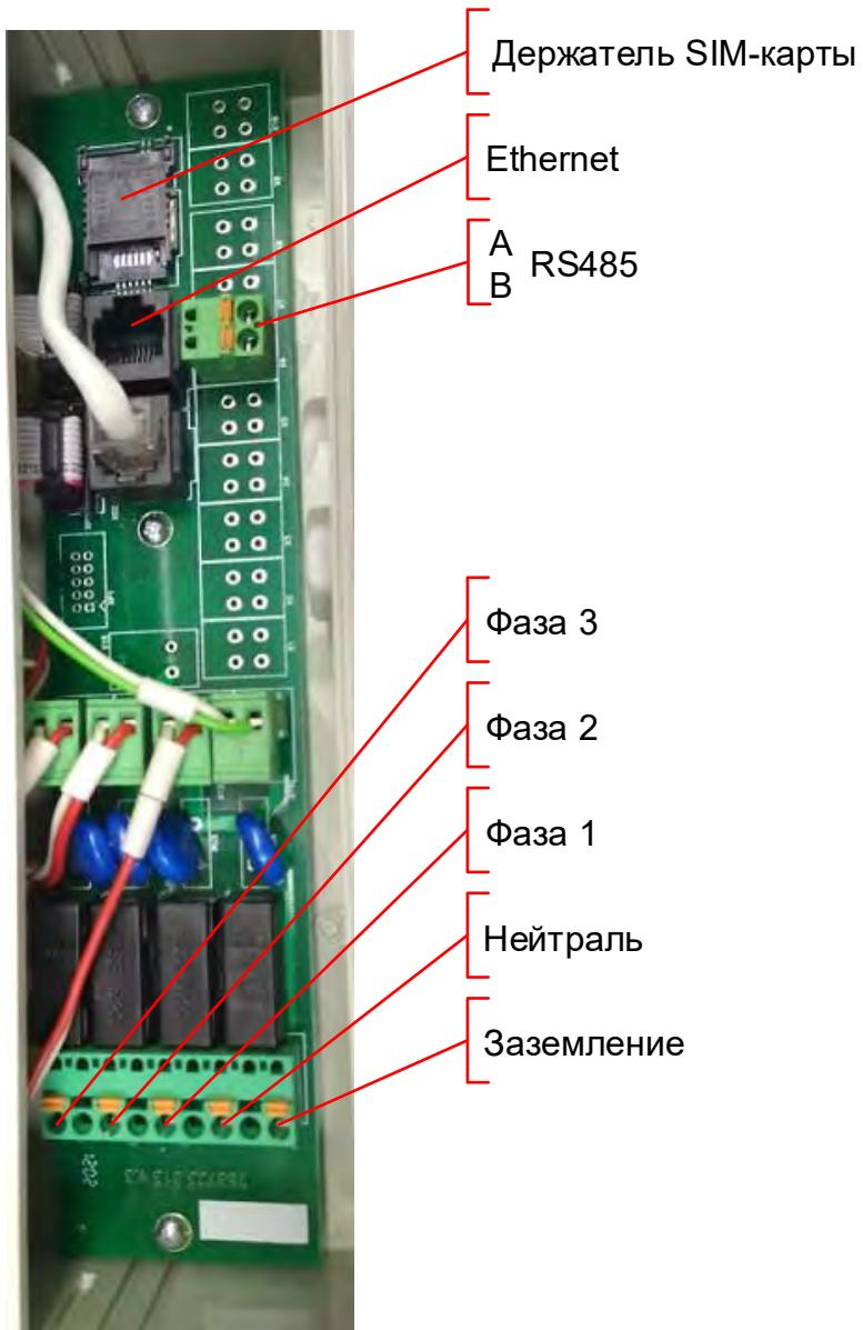
**Рисунок В.1 – Назначение контактов разъемов УСПД**
