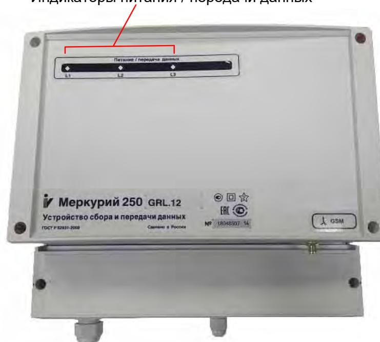
*Рисунок 3.1 – Элементы индикации УСПД*
