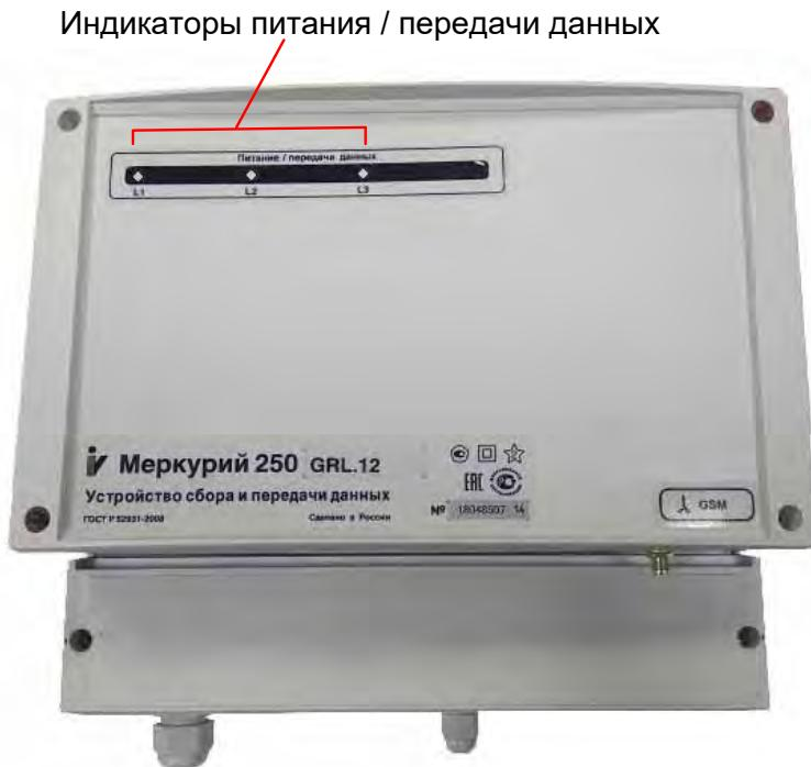
*Рисунок 3.1 – Элементы индикации УСПД*
